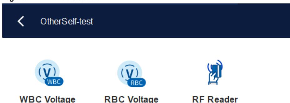
3. Fare clic su RBC Aperture Voltage (Tensione apertura RBC) per avviare il test automatico. Il sistema eseguirà le corrispondenti operazioni di autotest. Al termine dell'autotest, verrà visualizzata una finestra di dialogo per mostrare i risultati dell'autotest.
